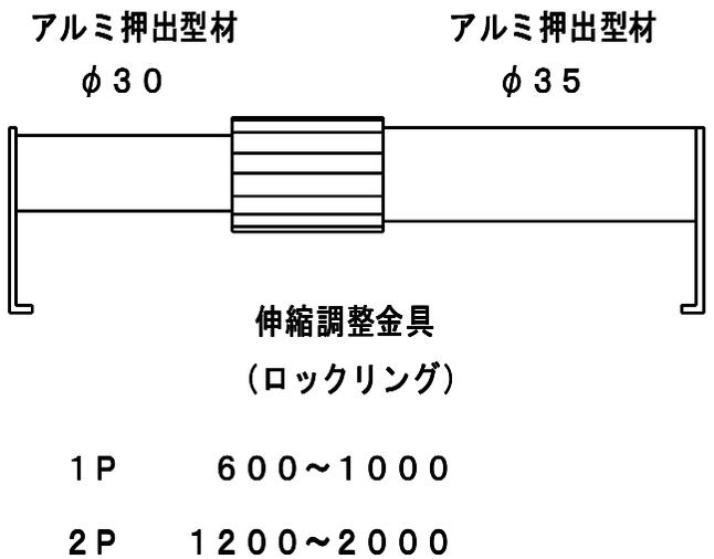
伸縮調整が上記寸法内ででき、ロックリングにて任意箇所に固定する事ができます。
